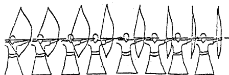
■ 矢が発射される過程のトレース図 彼はハズを境として上下に緊張と弛みが見られる。
